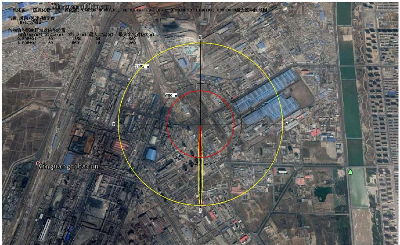
图5 高炉煤气管道泄漏影响范围图
