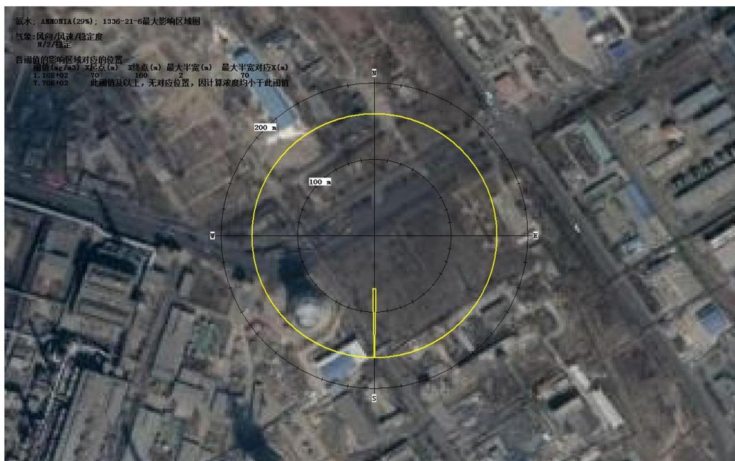
图 11 氨水储罐泄漏在最不利气象条件下影响范围图
